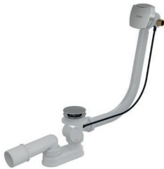
Szögletes kádfeltöltős le- és túlfolyó rendszer bovdenes kivitellel. Hossza: 570, 800 mm. Cikkszám X01438, X01504
